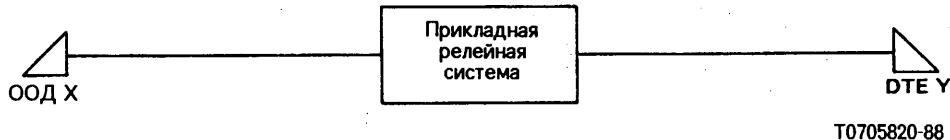
С точки зрения абонента, в случае (B) нет нужды рассматривать фактическую конфигурацию прикладных релейных систем. Прикладная релейная система может, например, состоять из одной прикладной ФВ, двух взаимосоединенных прикладных ФВ...
