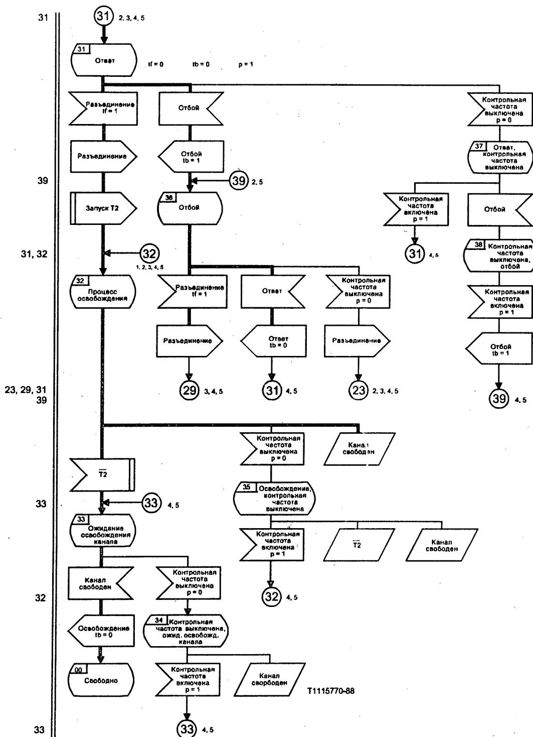
Линейная сигнализация системы R2: преобразование входящего аналогового варианта в исходящий цифровой вариант, контроль контрольной частоты вторичной группы
