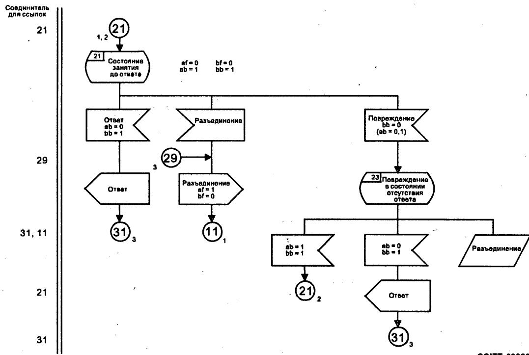
Линейная сигнализация системы R2: преобразование исходящего аналогового варианта в исходящий цифровой вариант
