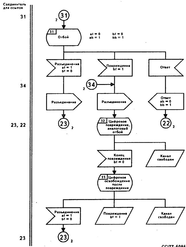
Линейная сигнализация системы R2: преобразование входящего
