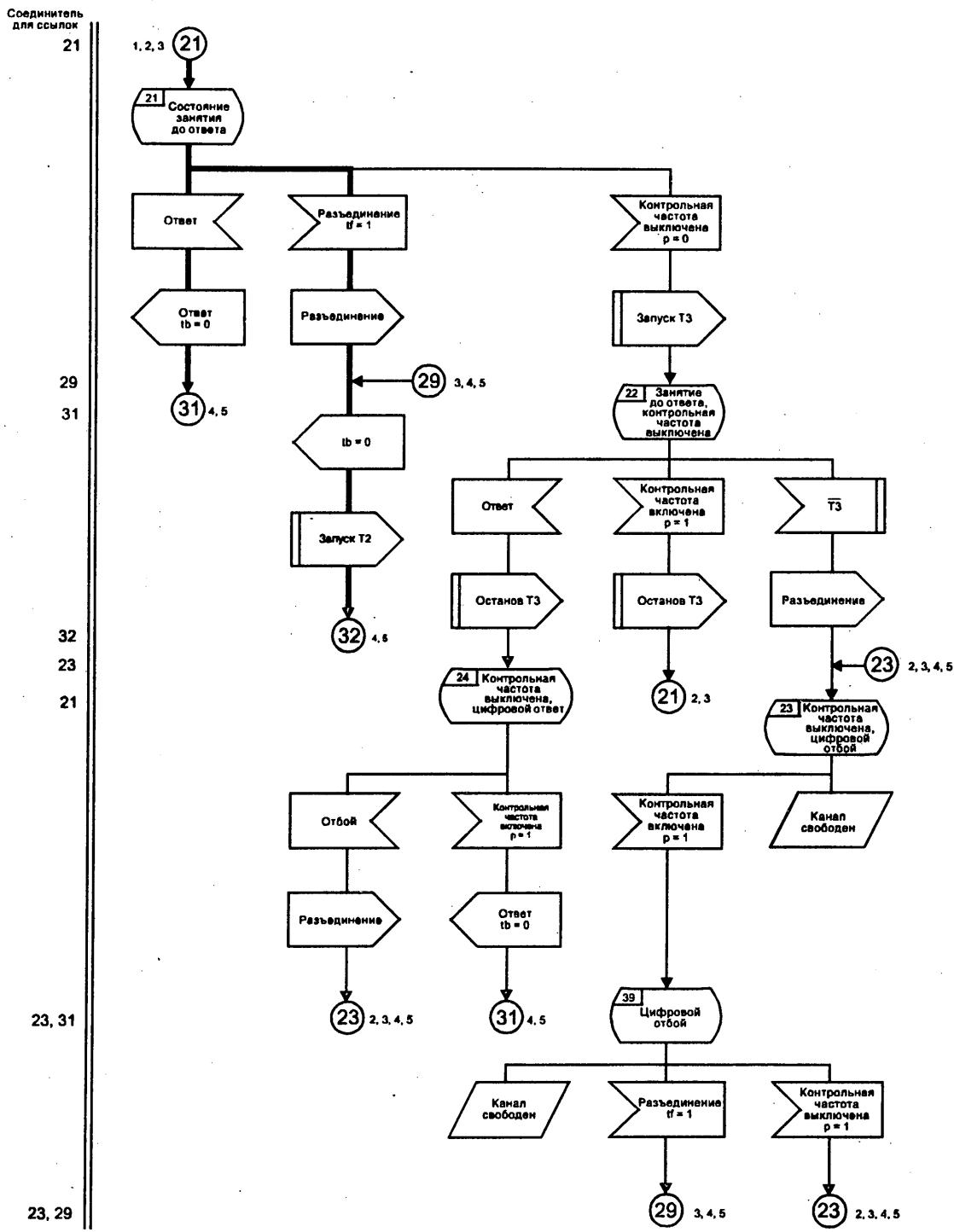
Линейная сигнализация системы R2: преобразование входящего аналогового варианта в исходящий цифровой вариант, контроль контрольной частоты вторичной группы
