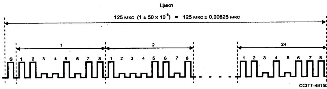
Частота дискретизации  $8000 (1 \pm 50 \times 10^{-6}) \text{ Гц} = 8000 \pm 0,4 \text{ Гц}$
