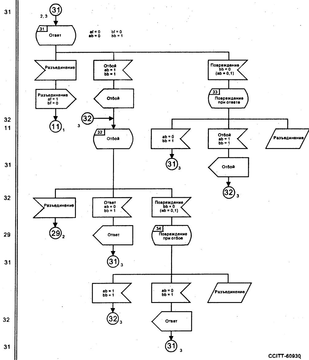
Линейная сигнализация системы R2: преобразование входящего аналогового варианта в исходящий цифровой вариант
