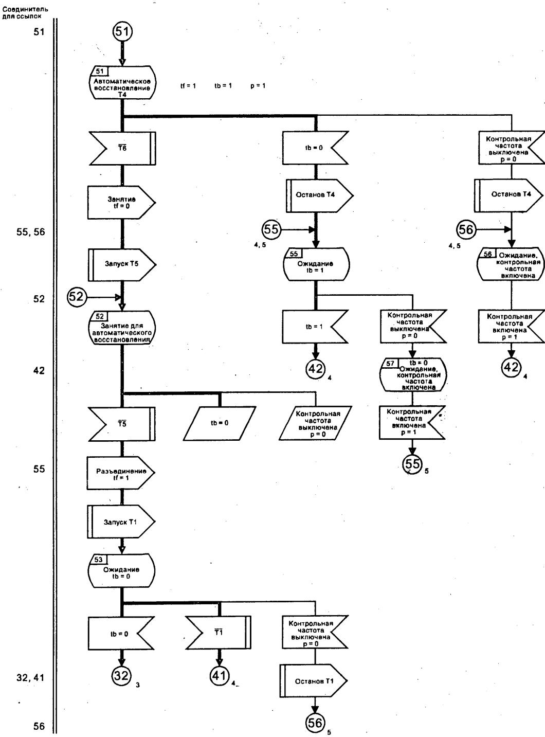
Линейная сигнализация системы R2: преобразование входящего цифрового варианта в исходящий аналоговый вариант.
