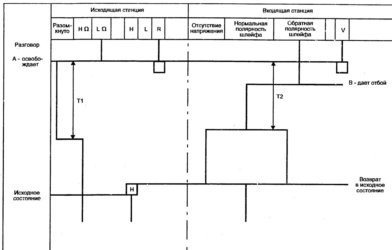
c) В - дает отбой во время разомкнутого шлейфа на исходящей станции (без тарифных импульсов
