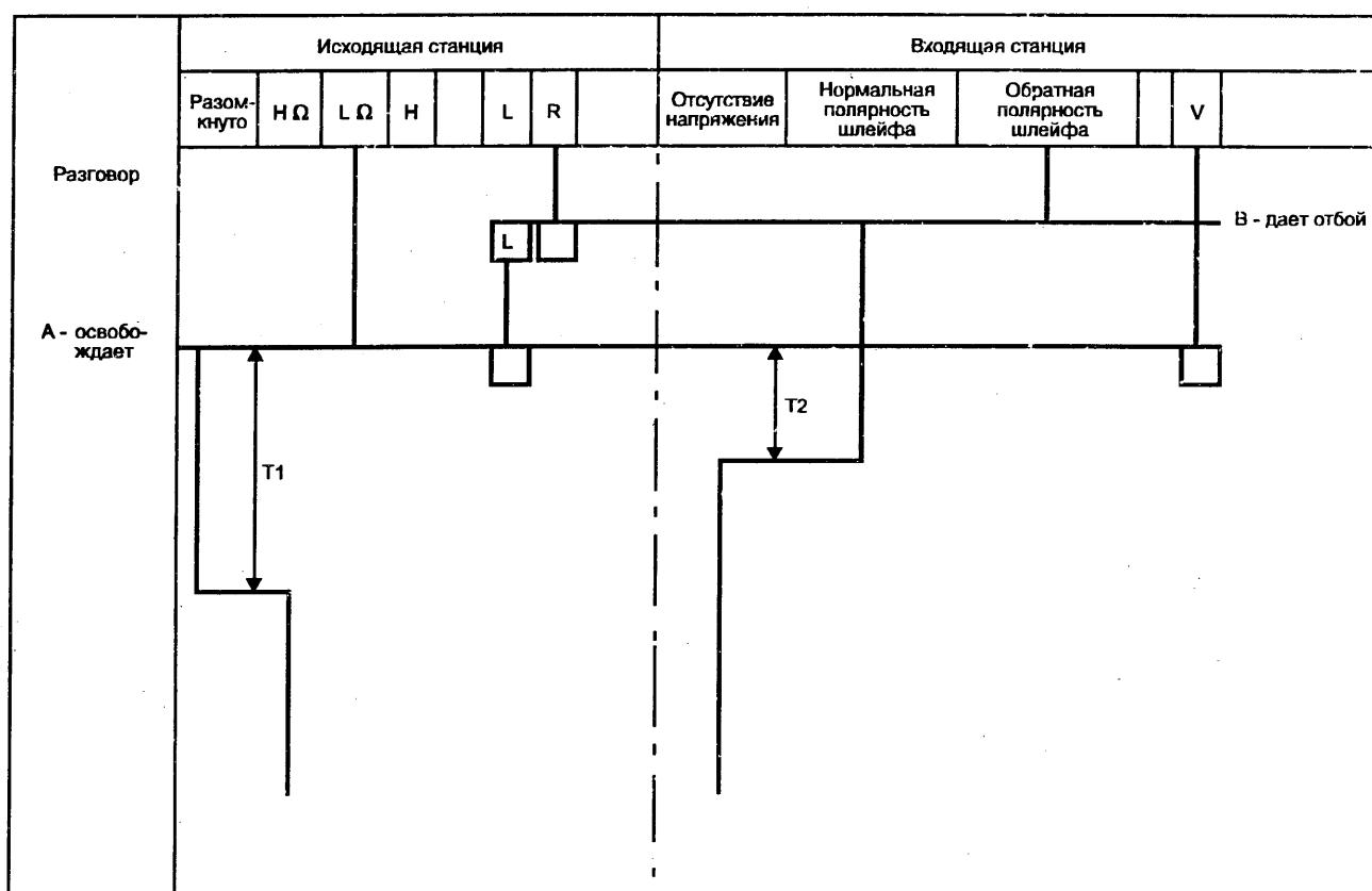
d) В соединении с освобождающимся абонентом входящая станция дает блокировку при помощи размыкания шлейфа (без тарифных импульсов)
