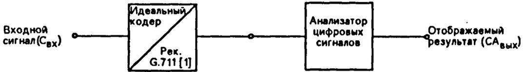
б) Погрешность, вносимая цифровым анализатором -  $CA_{вых} - IC_{вых} - П_{ЦА}$
