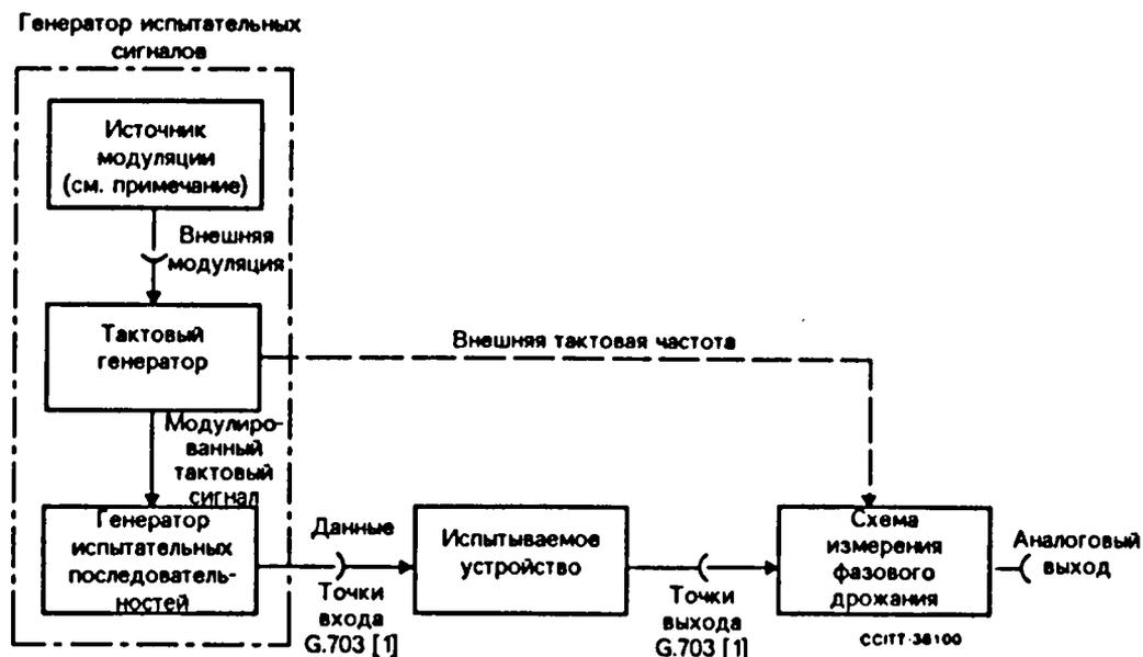
*Примечание.* – Источник модуляции, служащий для проверки на соответствие Рекомендациям серии G.700, может размещаться внутри тактового генератора и/или внутри генератора испытательных последовательностей. Этот источник может также устанавливаться отдельно.
