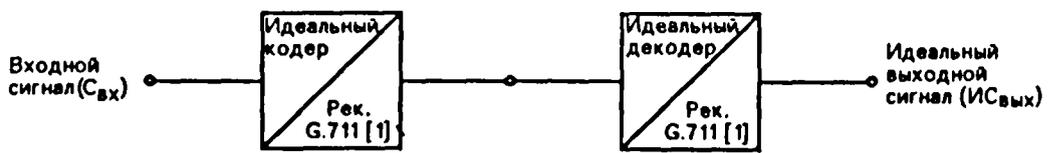
а) Погрешность идеального канала ИКМ -  $IC_{вых} - C_{вх}$
