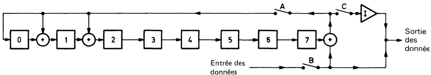
Pour la transmission des bits d'information: les commutateurs A et B sont fermés, le commutateur C est ouvert.
