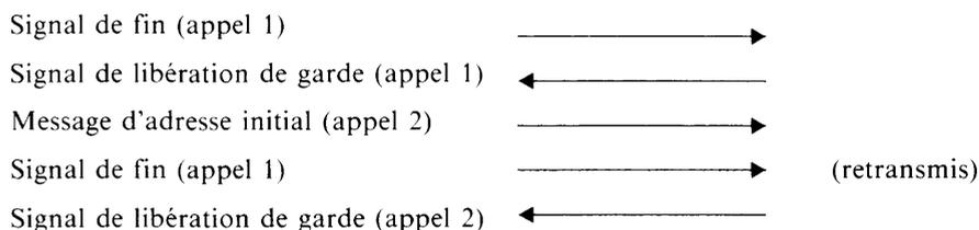
Le processeur, qui reçoit le signal de libération de garde, ignore si ce dernier est la réponse à un signal de fin retransmis ou s'il résulte d'une erreur à l'arrivée non détectée.
