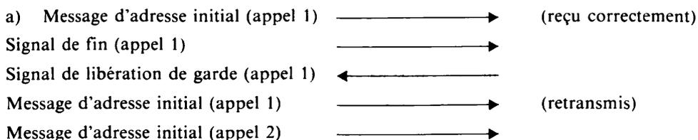
Cette séquence ressemble quelque peu à celle qui existe lorsqu'un message d'adresse initial est reçu à deux reprises parce qu'une ACU est arrivée sous une forme erronée ou à la suite d'une compensation de dérive et sans qu'un signal de fin intervienne [voir l'exemple c) au § 4.7.3]. Il convient de comparer le contenu des deux messages d'adresse initiaux. S'ils diffèrent, l'appel peut être rejeté par l'envoi d'un *signal de confusion* vers l'arrière.
