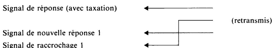
Le signal de nouvelle réponse est accepté sous condition, en attendant la réception du signal de rattachement.
