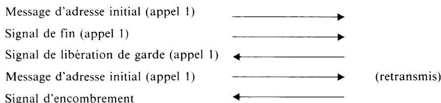
Le processeur, qui reçoit le signal d'encombrement, constate que le circuit associé est en état de repos et considère ce signal comme non valable. Le processeur de l'autre extrémité maintient le circuit occupé dans l'attente du signal de fin.
