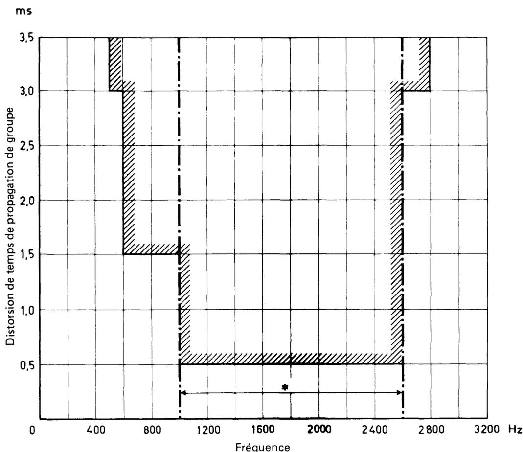
\*Bande de fréquences dont les caractéristiques sont définies pour le système de signalisation n° 6. Le gabarit des tolérances est celui indiqué dans la Recommandation M.1020.
