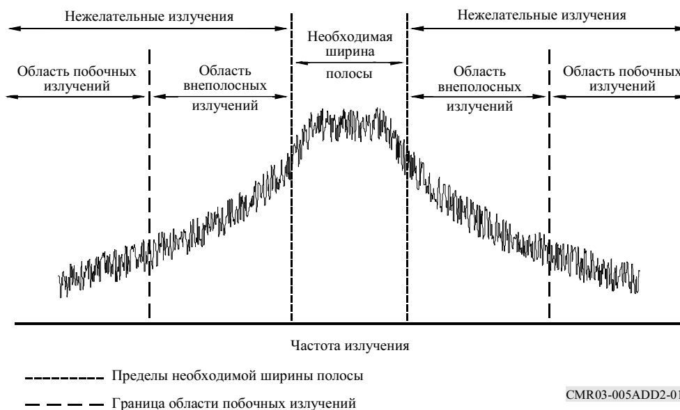
РИСУНОК 1 Области внеполосных и побочных излучений
