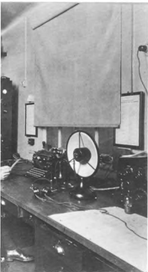
180 *Un récepteur de radiodiffusion allemand de 1923 (modèle appelé « le train express »). De gauche à droite: amplificateur H.F., récepteur, amplificateur B.F.*
